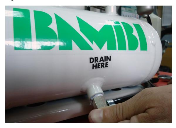
Giraremos la válvula marcada como Drain Here, dejando escapar todo el aire y restos de agua del interior del calderin. Actúe con precaución, ya que el aire sale con mucha presión y pequeñas cantidades de aceite puede ser arrastradas con el agua.
