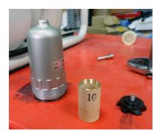
Para desmontar el filtro secundario desenrosque la parte inferior de la válvula en el sentido horario, retire el filtro de color dorado y límpielo con alcohol o disolvente no muy agresivo. Seque muy bien el filtro y colóquelo de nuevo en el compresor.
