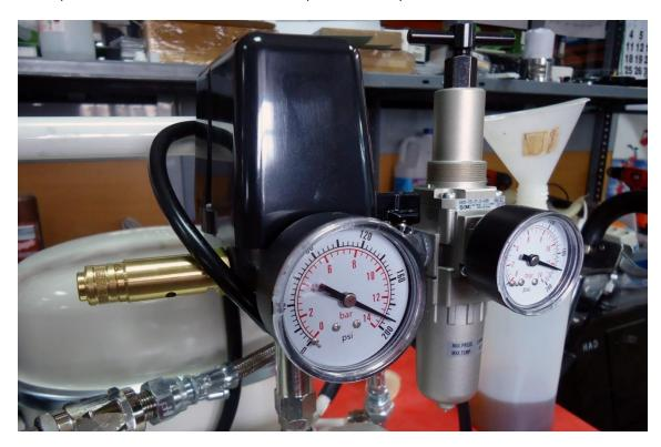
De izquierda a derecha puede observar, el tubo de color dorado, que es la válvula de seguridad, esta evitaría el aumento descontrolado en caso de fallo del regulador de presión. Manómetro de la presión del calderin, puede llegar hasta 14 bares pero nunca superarlo. Manómetro de salida, limitado en nuestro taller hasta las 12 atmosferas. No recomendamos su manipulación, pero si es necesario puede modificar la presión con la palometa de color negro de la parte superior.
