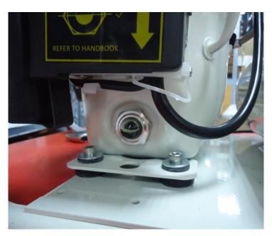
Dependiendo del uso de su compresor el aceite se ira deteriorando, por lo que tendrá que cambiarlo. Para hacerlo quite el filtro de aire, desenrosque el visor con una llave adecuada, tendrá que sacar el aceite usado por el orificio que deja libre el visor, vuelva a roscarlo con cuidado ya que tiene una junta de goma que es muy delicada.
